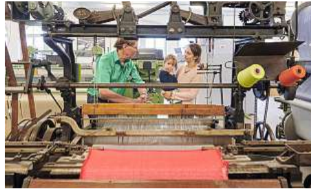
Webmaschine mit obenliegender Schafststeuerung – 2. Hälfte 19. Jhdt.
